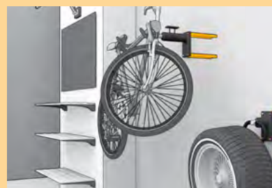
Raskaiden varustelaineiden jälkikiinnitys betonirakenteisiin
